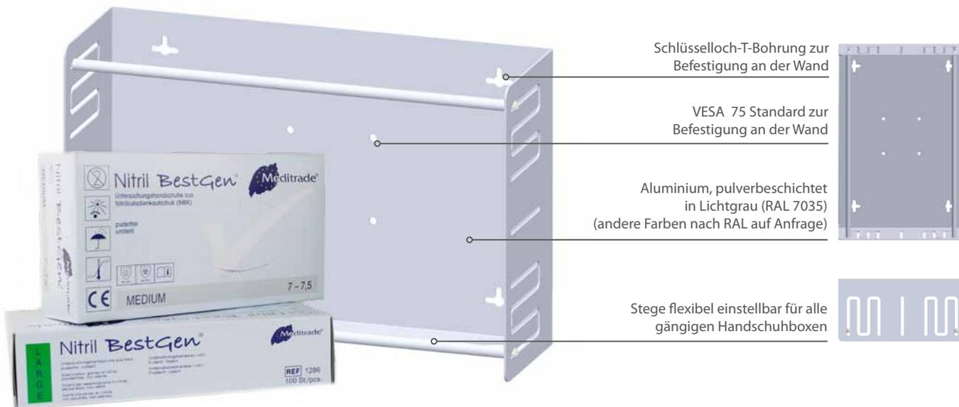
Unsere ALU FLEX Halterungen für Handschuhboxen aus edlem Aluminium wurden für drei, vier oder fünf Handschuhboxen entwickelt. Eine flexible Schienenführung ermöglicht eine variable Anpassung in der Breite und Tiefe. Zudem kann der Anwender die Halterungen ALU FLEX sowohl horizontal als auch vertikal einsetzen. Glatte Oberflächen ermöglichen eine optimale Reinigung dank Pulverbeschichtung.
